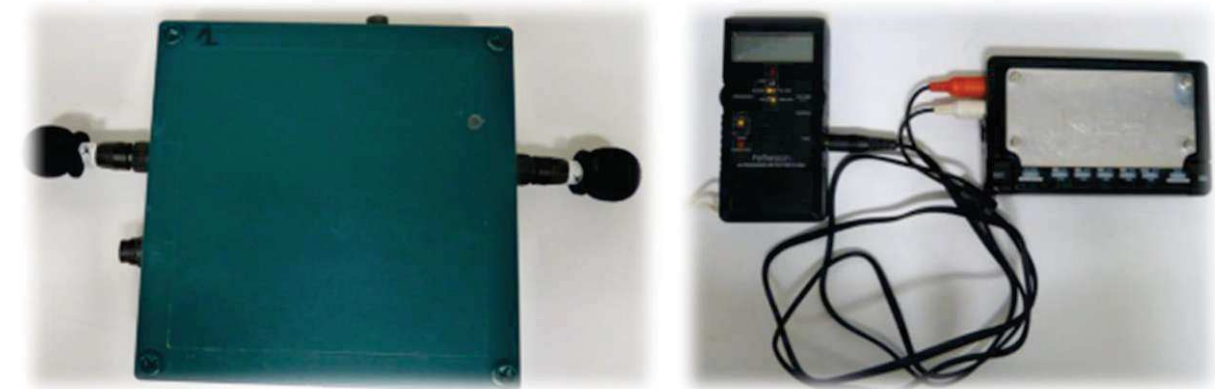
Matériel de détection ultrasonore utilisé (SM2 Bat à gauche et détecteur Pettersson à droite)
